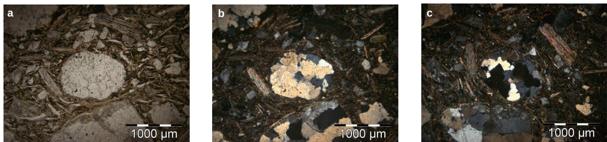
Figures 42 : Bdx 10223 : Images en lumière polarisée non analysée (a) et lumière polarisée analysée (b, c). Observation de grains polyphasés de quartz ou de quartz associés à des feldspaths ou des zircons, confirmant les observations obtenues par cathodoluminescence.
